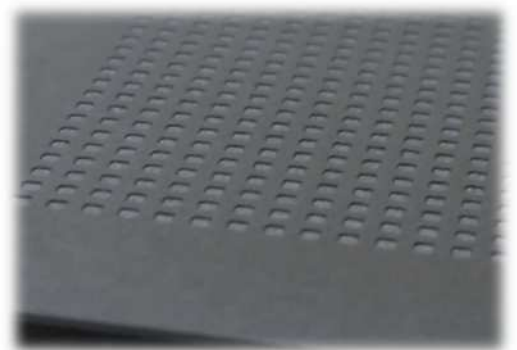
シート表面に微小窪みパターンを形成 Forming micro-depression pattern on the surface of the porous sheet.
